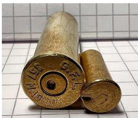
Due bossoli sparati: a sinistra un bossolo cal. 357 Magnum a percussione centrale. A destra notare il cal. 22 Lr a percussione anulare, l'impronta del percussore è periferica/RimFire rispetto al bossolo a sinistra, in quella zona c'è la miscela innescante che dà inizio a tutta la catena esplosiva.
