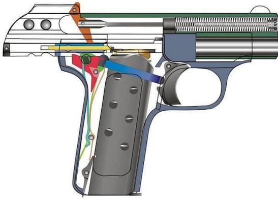
In alto: ora il bossolo visto precedentemente è espulso e viene camerato un nuovo colpo nella camera di cartuccia. La molla di recupero è totalmente compressa, alla chiusura del carrello la leva di scatto intercetta la parte posteriore del percussore, mentre un'appendice della leva di riarmo marrone entra nello scasso anteriore del percussore trattenendolo in posizione retratta/armata.
