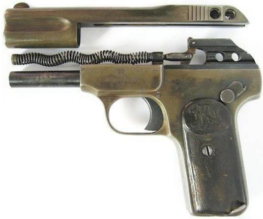
Il carrello separato dal fusto e dal blocco di riarmo, grazie alla rimozione delle due viti presenti – prima – sul lato sinistro del carrello. La fase successiva riguarda la rimozione del blocco di riarmo dal fusto facendo pressione sulla molla di recupero.
