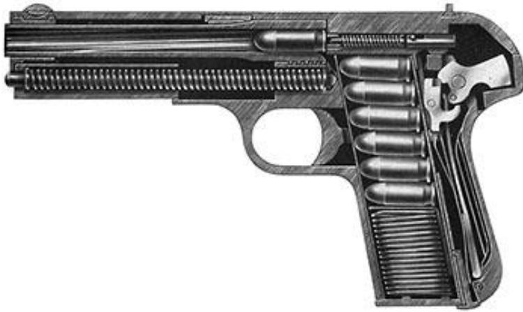
La vista interna della Browning M1903, diversa rispetto alla versione precedente. Possiamo notare il cane interno in posizione armata, con la molla di recupero sotto la canna. Rimaniamo sulla canna, alla base inferiore esterna della camera di cartuccia sono ricavate cinque nervature, un
