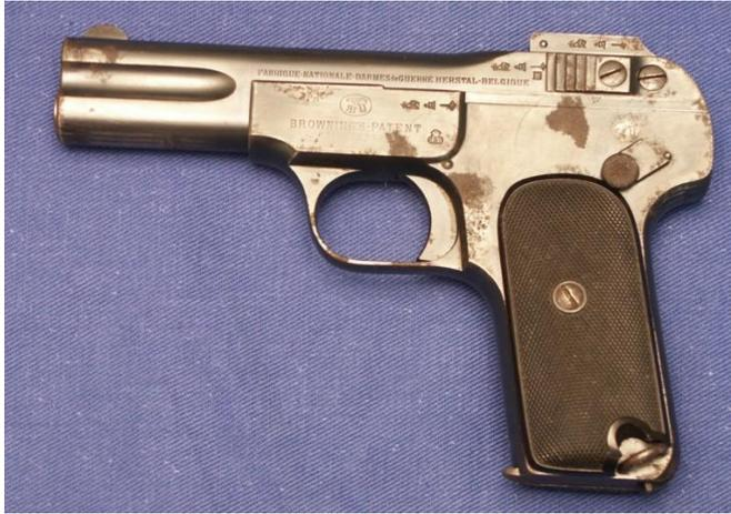
Una M1900 dotata delle guancette originali Browning: zero loghi di fabbrica e superficie totalmente zigrinata. Un'arma abbastanza vissuta date le macchie di ruggine sul metallo.
